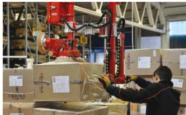
L'étiquette est apposée automatiquement sur le colis, fermé et sécurisé par un film qui garantit le scellage et une meilleure protection contre les agents atmosphériques, et placé sur une palette à l'aide d'un système de manipulation qui permet à l'opérateur d'éviter les efforts de soulèvement en réduisant la fatigue.
